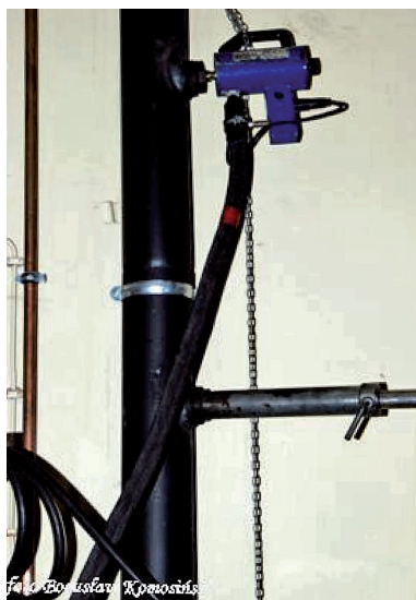
Rysunek 14. Widok odcinka pomiarowego wraz z sondami pyłomierza i analizatora spalin
