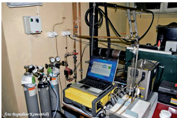
Rysunek 15. Stanowisko analizatora spalin DX-4000
