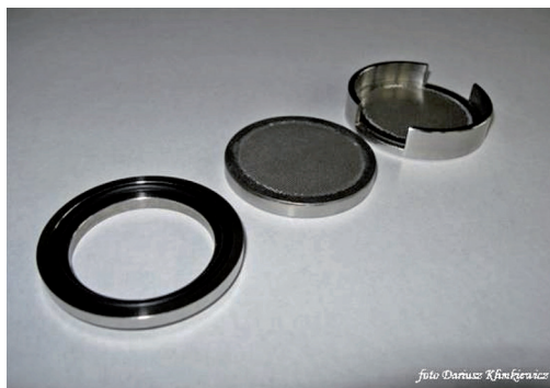
Rysunek 22. Elementy gniazda filtra stosowanego w głowicy CVS (pierścień uszczelniający, podkład filtra właściwego i dno gniazda)
