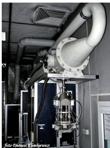
Rysunek 20. Kanał rozcieńczający spaliny (Constant Volume Sapler prod. AVL) z zespołem głowic do pobierania próbek pyłu
