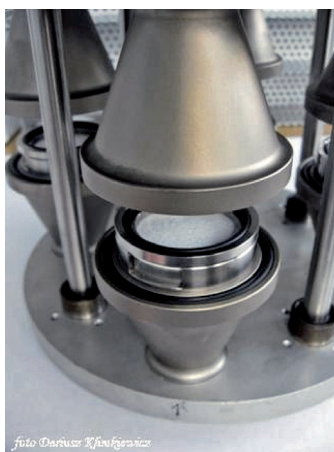
Rysunek 21. Głowica do pobierania próbek pyłu
