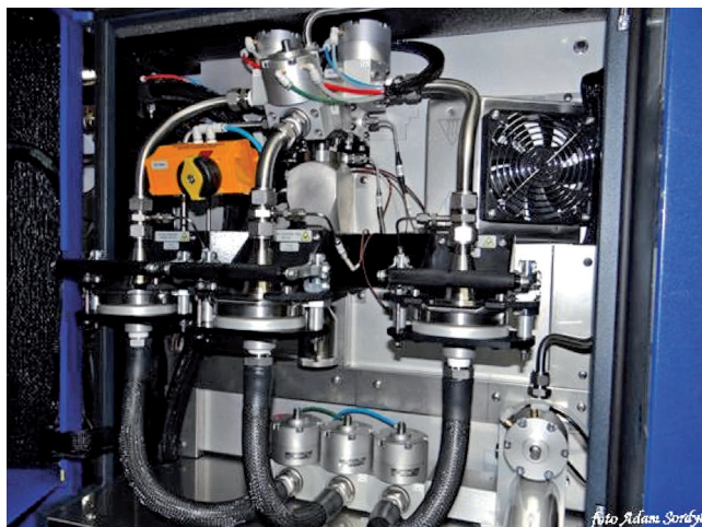
Rysunek 24. Panel z głowicami do pobierania próbek pyłu (Smart Sampler)
