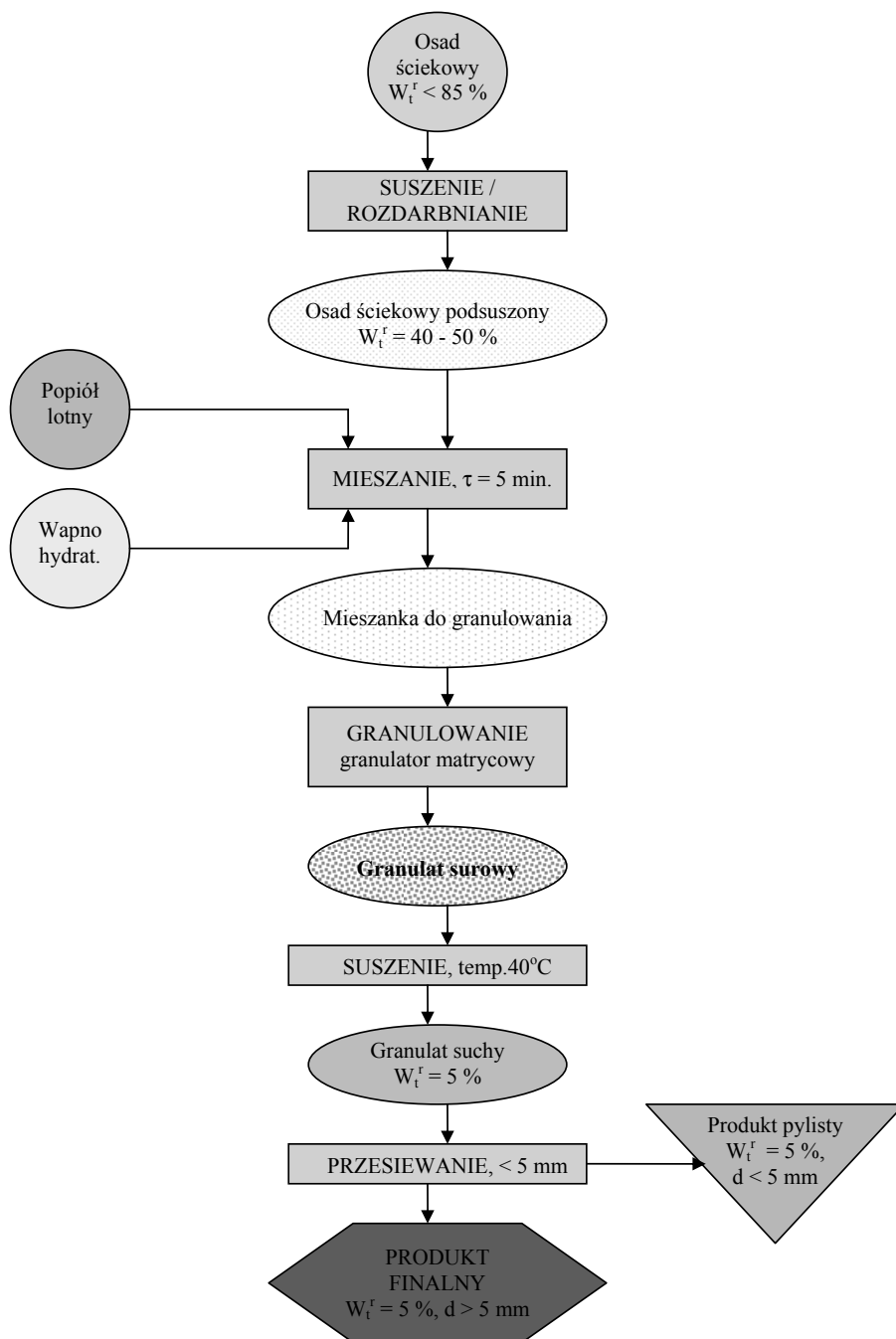
Rys. 45. Schemat blokowy procesu wytwarzania niemodyfikowanego granulowanego środka kondycjonującego glebę
