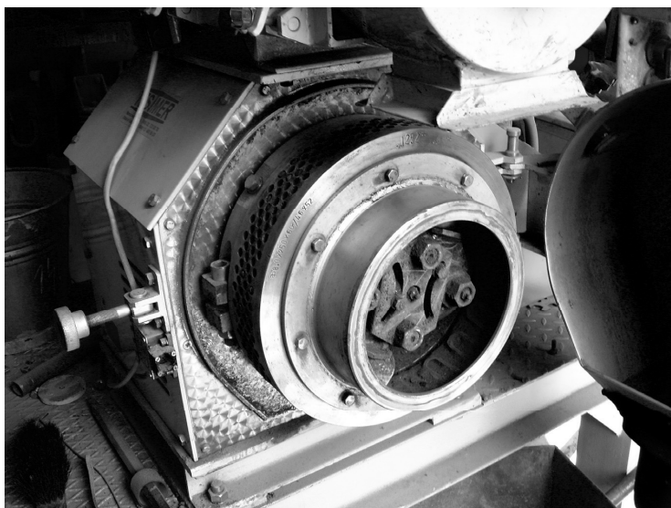
Rys. 48. Granulator z matrycą pierścieniową typ PD-1
