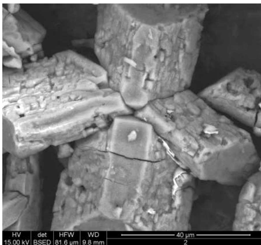
Rysunek 54. Sposób tworzenia aglomeratów z pojedynczych kryształów struwitu
